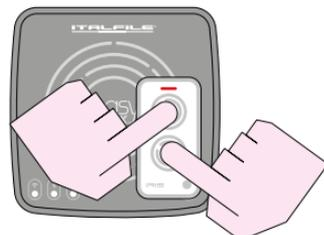
1. Appuyez simultanément sur les boutons jusqu'à ce que la Led de la télécommande clignote en vert.
