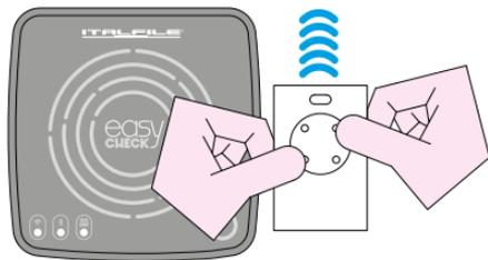
1. Éloignez la télécommande d'EasyCHECK et appuyez simultanément sur les boutons 1 et 2 jusqu'à ce que la Led de la télécommande clignote.
