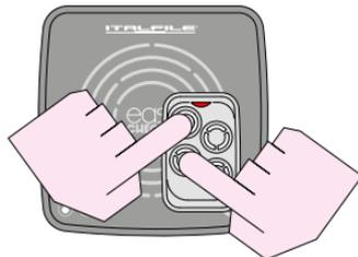
1. Appuyez simultanément sur les boutons jusqu'à ce que la Led de la télécommande clignote en vert.
