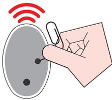
Bei den MITTO-Versionen, falls die Taste auf der Rückseite der Fernbedienung vorhanden ist, drücken Sie ausschließlich diese Taste.
